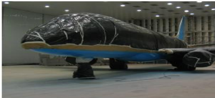
Figura 16- Processo de pintura
