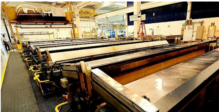
Figura 8- Tanque de tratamento químico.
