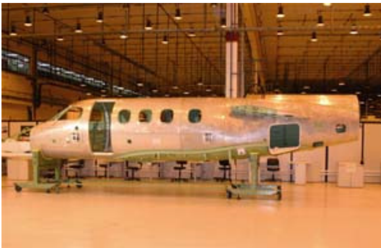
Figura 13- Junção das fuselagens Phenom 100
