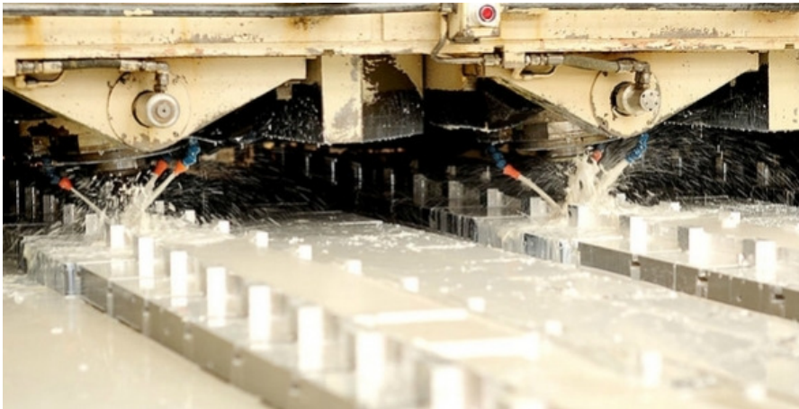
Figura 5- Usinagem das placas
